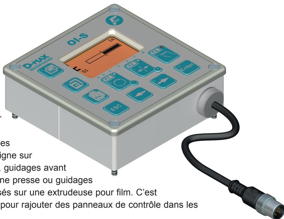
Le boîtier de télécommande OI-S est la solution de base pour contrôler les processeurs D-MAX dédiés aux applications élémentaires telles que les guidages par le bord et par suivi de ligne sur un dérouleur sur machine de refente, guidages avant impression ou au rembobinage sur une presse ou guidages par le centre avec détecteurs motorisés sur une extrudeuse pour film. C'est également une solution économique pour rajouter des panneaux de contrôle dans les applications D-MAX en réseau.
