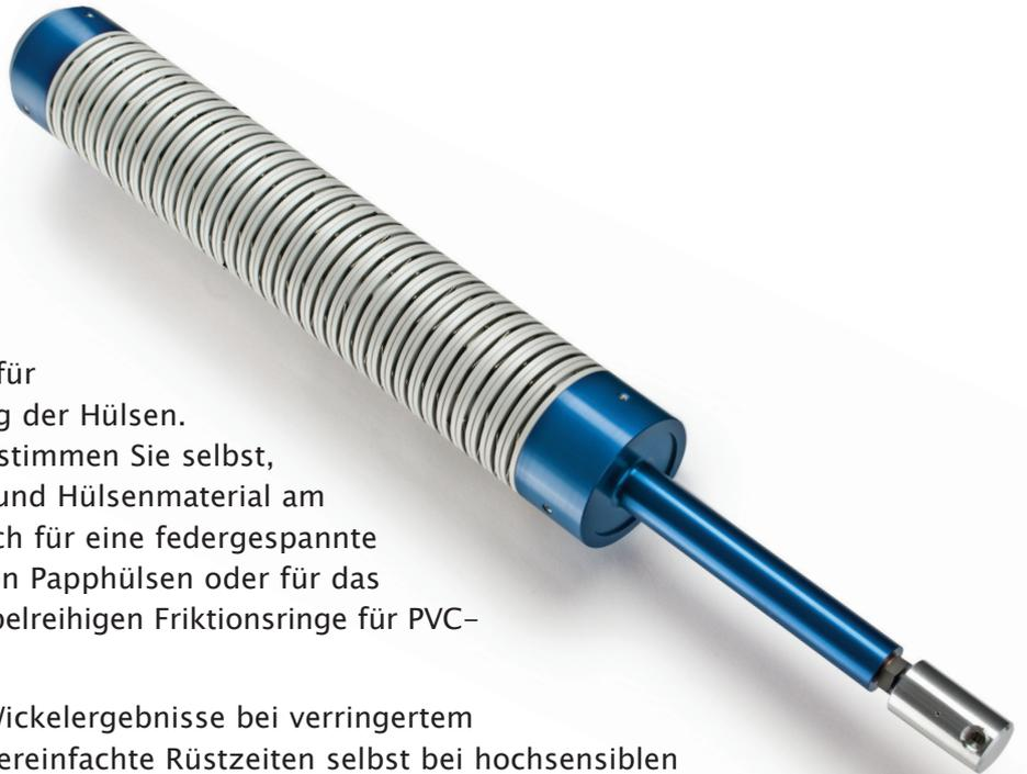
Die Tidland Friktionswelle D490 sorgt für zuverlässige Spannung und Zentrierung der Hülsen. Durch austauschbare Friktionsringe bestimmen Sie selbst, welches System für Ihr Wickelmaterial und Hülsenmaterial am besten geeignet ist. Entscheiden Sie sich für eine federgespannte Ausführung (D490S) für den Einsatz von Papphülsen oder für das drehmomentaktivierte Design mit doppelreihigen Friktionsringe für PVC- und Papphülsen (D490B).
