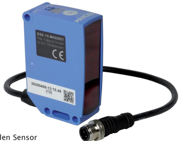
Der Reflexionslichtsensor DSE-15 ist ideal für die meisten Anwendungen mit matten, transparenten oder reflektierenden Materialbahnen geeignet.
