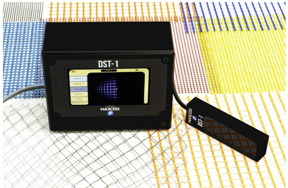
Mit dem Sensor DST-1 können anspruchsvolle Materialien geführt werden, bei denen andere Sensoren nicht einsetzbar sind. Sie können zwischen Kanten und Linien sowie zwischen kleinen und großen Sichtbereichen wechseln, ohne den Sensor tauschen zu müssen. Der DST-1 benötigt weder eine externe Lichtquelle noch einen Reflektor. Er bietet die Möglichkeit, die Bahn nur von einer Seite zu erfassen.
