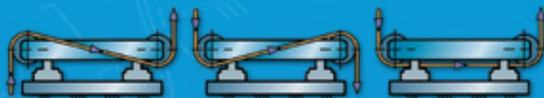
**Ulteriori stili di incorsamento del nastro**
