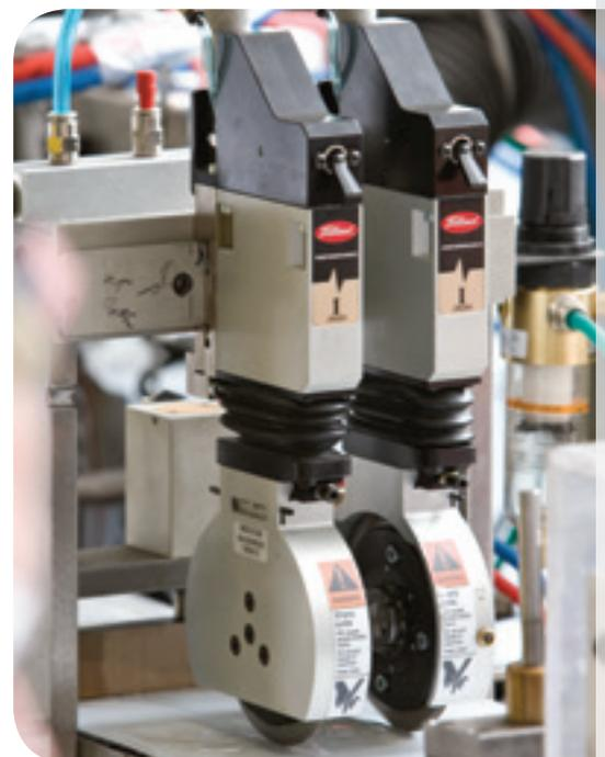
*Sistema de corte manual con portacuchillas a presión*
