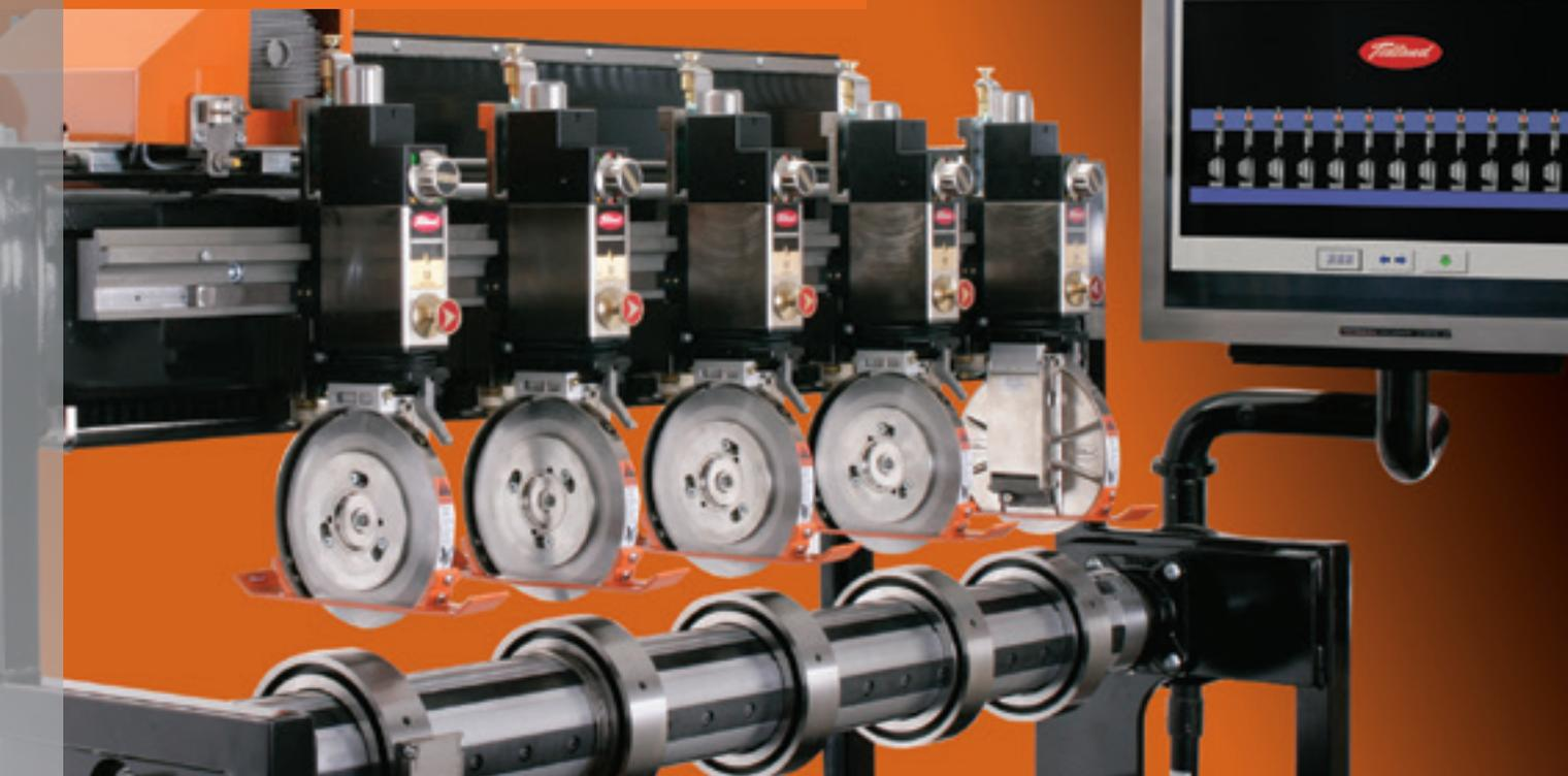
Los Sistemas Automatizados de Posicionamiento combinan la última tecnología y componentes de probada eficacia para aumentar la velocidad y la precisión de posicionamiento de las cuchillas, reducir al mínimo la frecuencia
