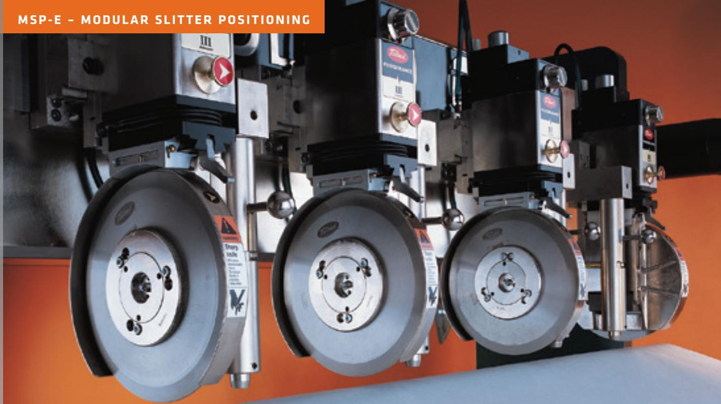
Il sistema Tidland MSP-E - Modular Slitter Positioning, garantisce un taglio affidabile e privo di problemi in applicazioni di finissaggio su larga scala o converting standard. Il sistema MSP-E riesce a riposizionare tutti i tagli in meno di 30 secondi (per un tipico cambio formato su taglierina/ribobinatrice) grazie alla tecnologia di posizionamento asincrona. La precisione di posizionamento ottenibile è di  $\pm 0.1$  mm con una ripetibilità di  $\pm 0.05$  mm.
