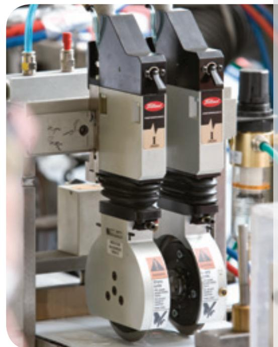
Sistema per taglio a pressione con posizionamento manuale
