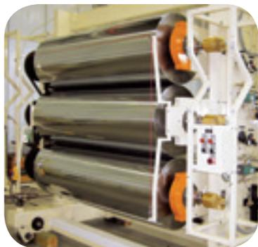
del nastro. Inoltre tutti i rulli prodotti da Webex sono sottoposti a controlli accurati per garantirne le caratteristiche meccaniche. Perna e corpo sono realizzati con i materiali più adatti e con elevata precisione. Sono inoltre
