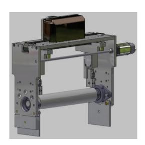
OEM框架之间的嵌入式安装套件(见表) 背面1x 0.75"销钉对准正面的1x 3/8"螺纹孔 2x 1.25"垫片和正面安装用紧固件 钻孔区域增加第二个前端安装孔
