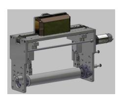
安装在OEM框架顶部的套件(见表) 2x 侧安装支架和紧固件 1X2" 立块
